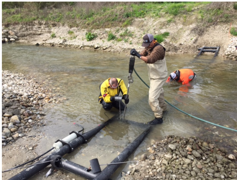
Abbildung 3 Montage der Antennenarrays in der Fischwanderhilfe
