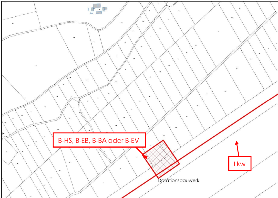
Abbildung 8: Lageplan mit Darstellung der Schallquellen - Bauarbeiten am Dotationsbauwerk
