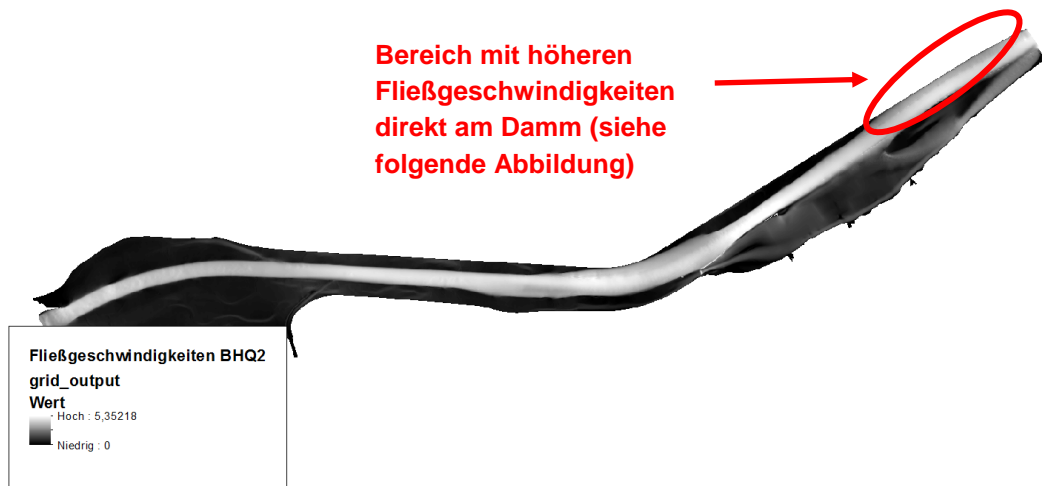
Abbildung 10 Fließgeschwindigkeiten [m/s] Stauraum Eggfling-Obernberg, BHQ 2
