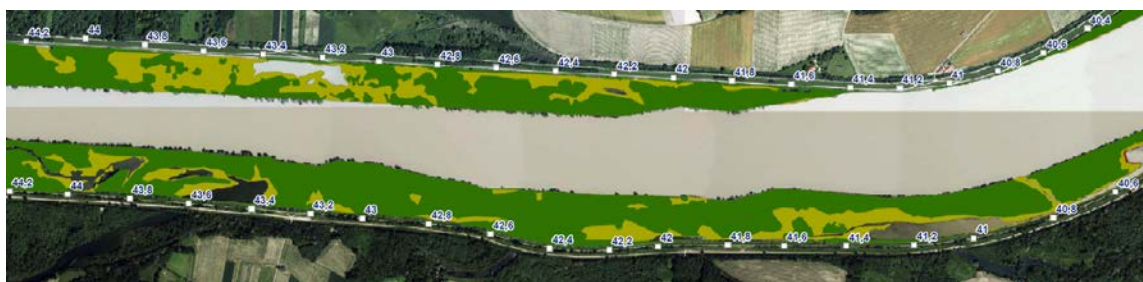
Abbildung 31: Verlandung zwischen km 40,6 und km 44,2 2013
