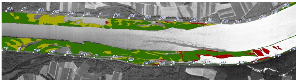
Abbildung 30: Verlandung zwischen km 40,6 und km 44,2 1976
