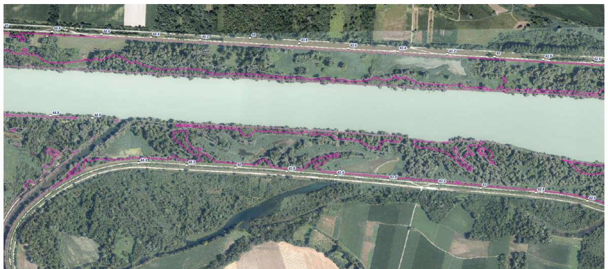
Abbildung 64: Anschlaglinien Bestand MHQ sowie MHQ – 2,0 m im Bereich ca. Fl.km 43,0/45,0 (Legende s. Abb. 63)
