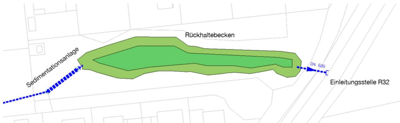
Abbildung 16: Skizzierte Sanierungsvariante mit Sedimentationsanlage und darauffolgendem Beckennutzung
