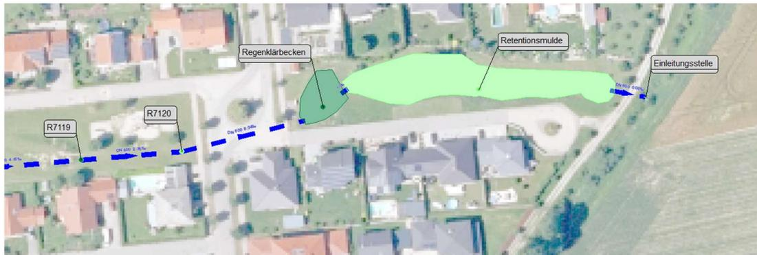
Abbildung 4: Detaillierte Darstellung der Gegebenheiten für das bestehende Regenklärbecken und die darauffolgende Retentionsmulde
