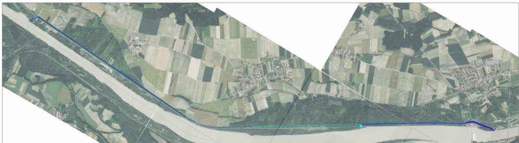
Abbildung 9: Übersicht Verlauf Variante L2-B: Gesamtlänge rd. 10km mit 2,8 km dynamisch dotierten Umgehungsarm
