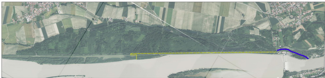
Abbildung 12: Übersicht Variante L4, Umgehungsgerinne mit 3,9 km Gesamtlänge, Anbindung OW mit 3,2 km langer „Rampe“ (Gelb)
