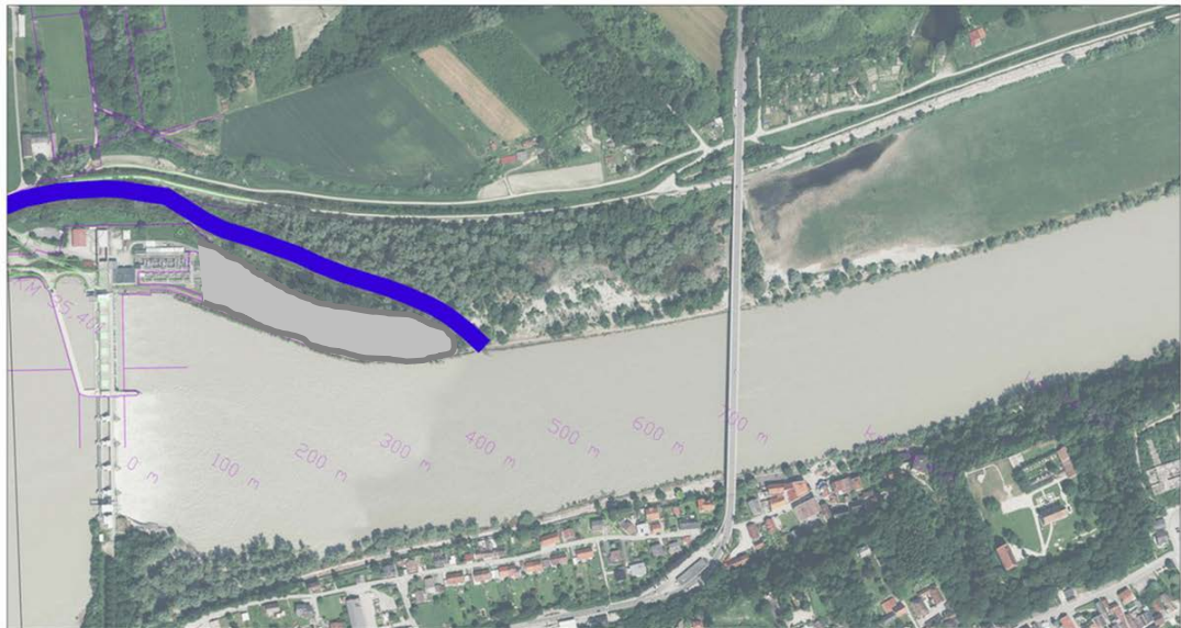
Abbildung 17: Verlauf Gerinne flussab vom KW-Durchlass, Lage Einstieg FAA (VL1-VL5), Leitdamm (grau)
