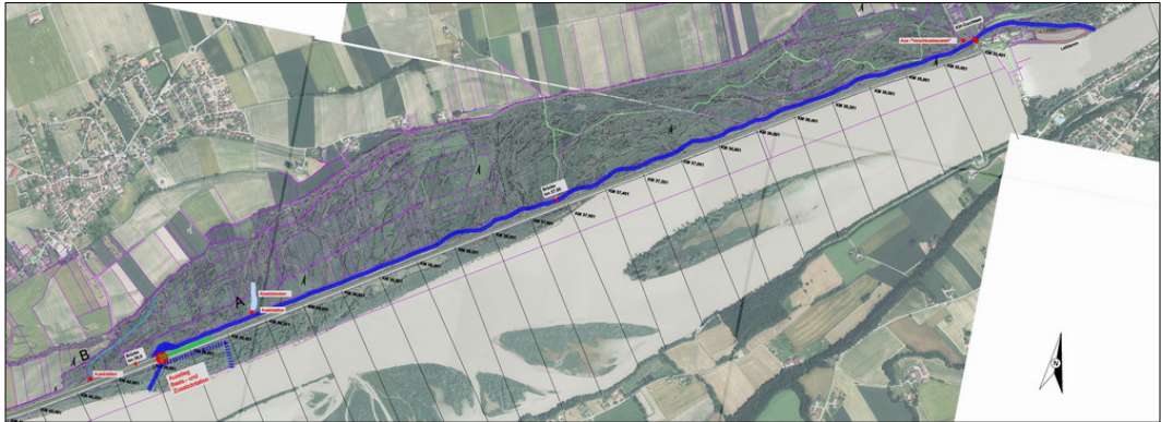
Abbildung 19: Übersicht Variante L3-A, 5km langer dynamischer Umgehungsarm, Anbindung OW mit z.B. Vertical Slot (Magenta) oder Asymmetrisches Raugerinne (Grün)
