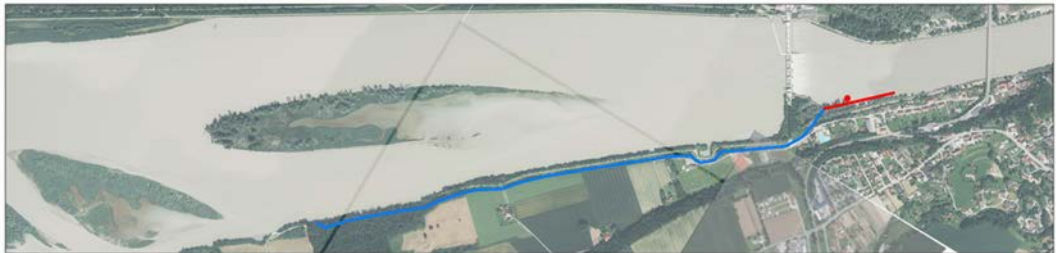
Abbildung 15: Übersicht Variante R2, Umgehungsgerinne (Hellblau) mit Vertical Slot (Rot)
