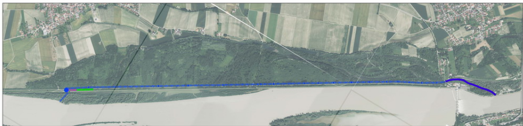
Abbildung 10_ Übersicht Variante L3-A, 5km langer dynamischer Umgehungsarm, Anbindung OW mit z.B. Vertical Slot (Magenta) oder Asymmetrisches Raugerinne (Grün)
