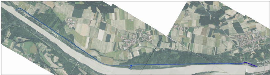
Abbildung 5: Übersicht Verlauf Variante L2-A, Gesamtlänge rd. 10km mit 5km dynamisch dotierten Umgehungsarm
