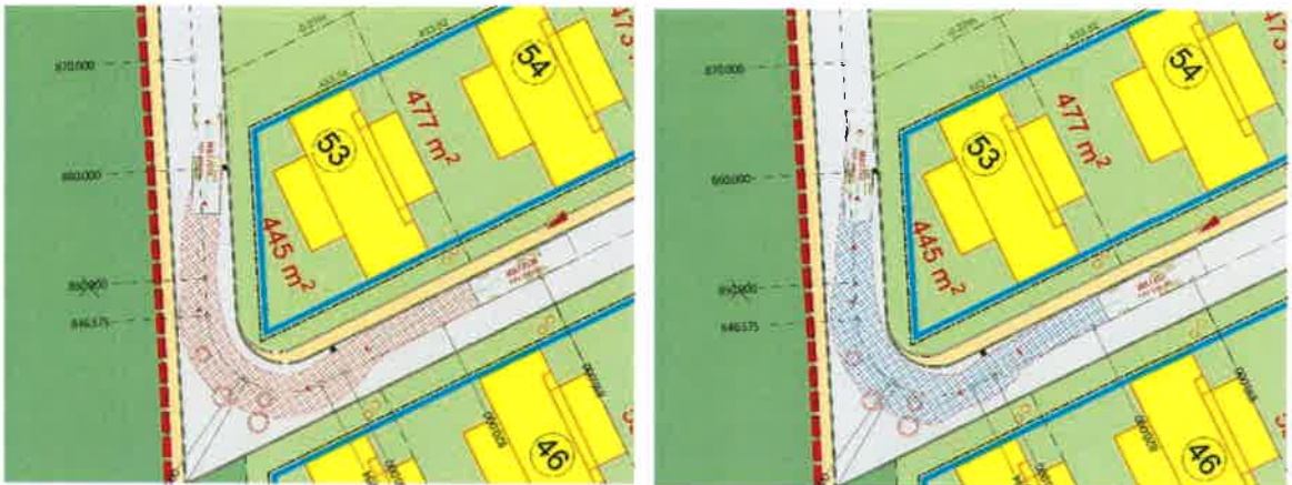
Schleppkurve eines 3-achsigen Müllfahrzeuge mit (links) und ohne (rechts) Nachlenkachse
