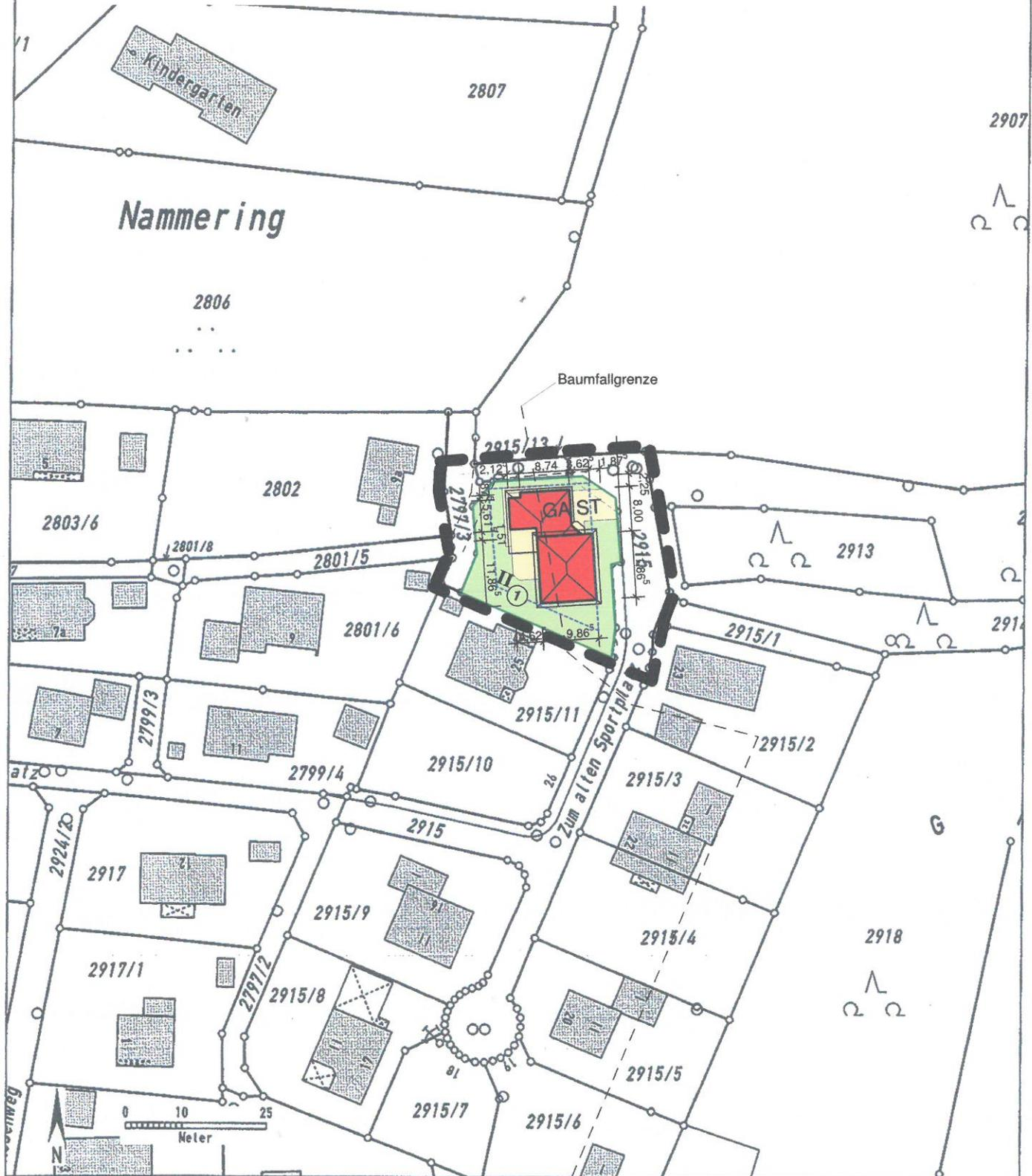
Auszug aus dem Katasterkartenwerk, Maßstab 1:1000, zur Bauvorlage nach §7 Abs.1 der Bauvorlagenverordnung.
