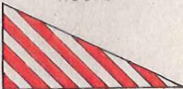
Sichtdreieck : Innerhalb dieser Fläche darf die Sicht ab 0.80 m Höhe über der Straßenoberkante durch nichts behindert werden
