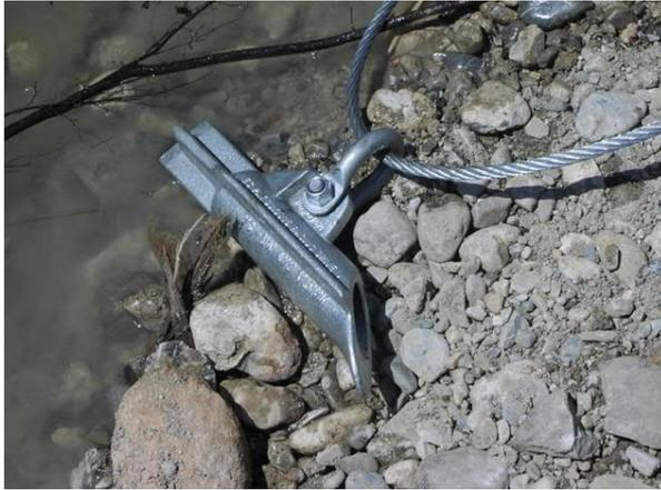
Abbildung 20: „Entenschnabel“-Anker zum Verankern schwerer Lasten in gewachsenem Kiesuntergrund
