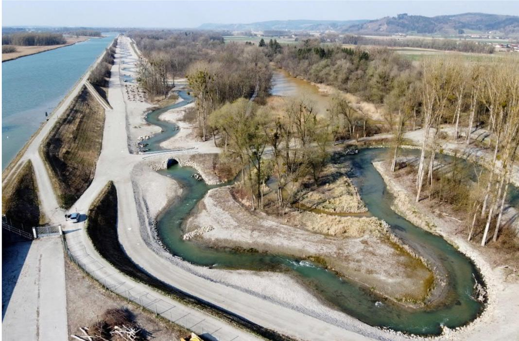
Abbildung 8: Beispiel Umgebungsgewässer am KW Ering-Frauenstein - Verlauf des Umgebungsgewässers im Aueniveau flussab der Anschüttung
