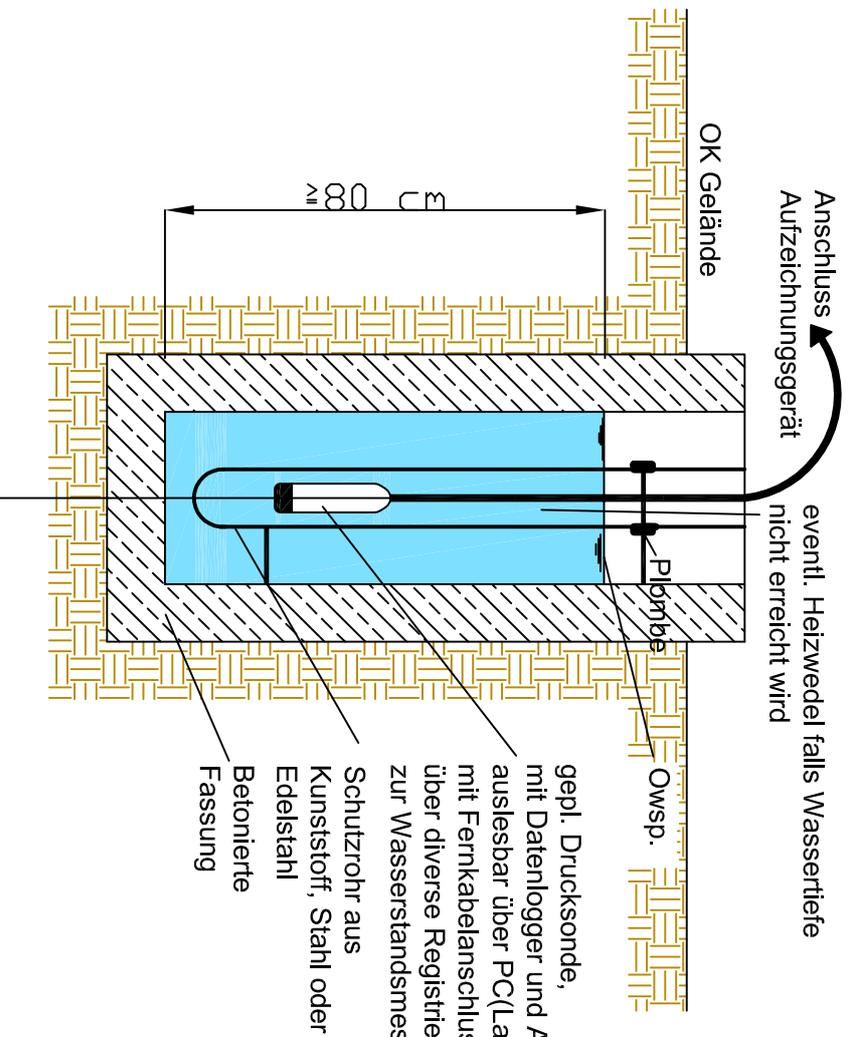
gepl. Drucksonde, mit Datenlogger und Alarmgeber, auslesbar über PC(Laptop) oder mit Fernkabelanschluss Aufzeichnung über diverse Registriergeräte, zur Wasserstandsmessung
